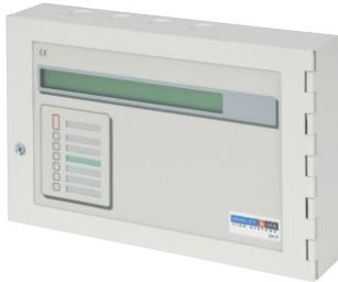
Stellt über ein 2 x 40 Zeichen LCD-Display mit Hintergrundbeleuchtung die Anzeigen der BMZ der Serie DXc dar. Eingebaute LEDs zum Anzeigen der BMZ-Zustände, reine Anzeigefunktion, keine Bedienung möglich.
