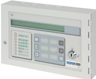
Dieses Bedienfeld hat die gleichen Anzeigen und technischen Merkmale wie das 709-701-001, jedoch mit zusätzlichen Bedienfunktionen. Die Freigabe der Tasten erfolgt mittels Schlüsselschalter. Bis zu 16 Fernanzeige- bzw. Fernbedienfelder können von der BMZ angesteuert werden.
