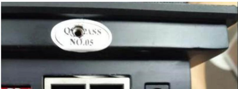
Abb. 45: ETCS-Originalsiegel beschädigt
